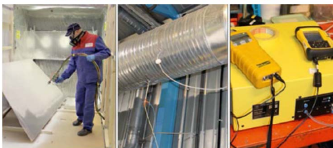
Тестовая камера для напыления гелькоута и приборы фиксирующие эмиссию стирола.
