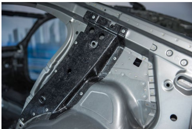
Рисунок 3. Задняя стойка кузова из полиэфирного листового прессматериала (SMC, в BMW 7 серии) [13]
