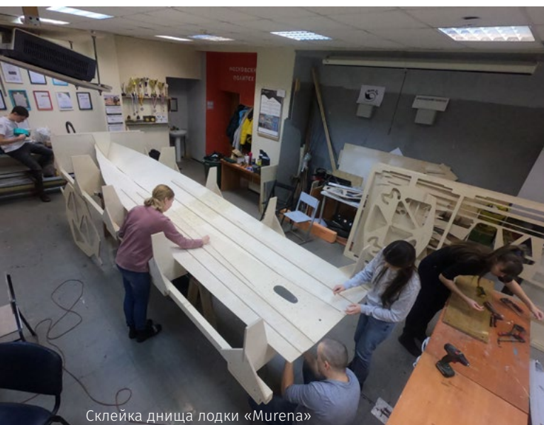
Склейка носовой части лодки «Murena»
