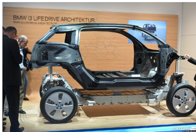
Рисунок 4. BMW i3. До 95% используемых материалов подлежат вторичной переработке [1].
