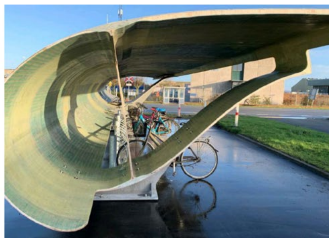
Рисунок 5. Примеры перепрофилирования лопастей ротора: навес для велосипедов [3].
