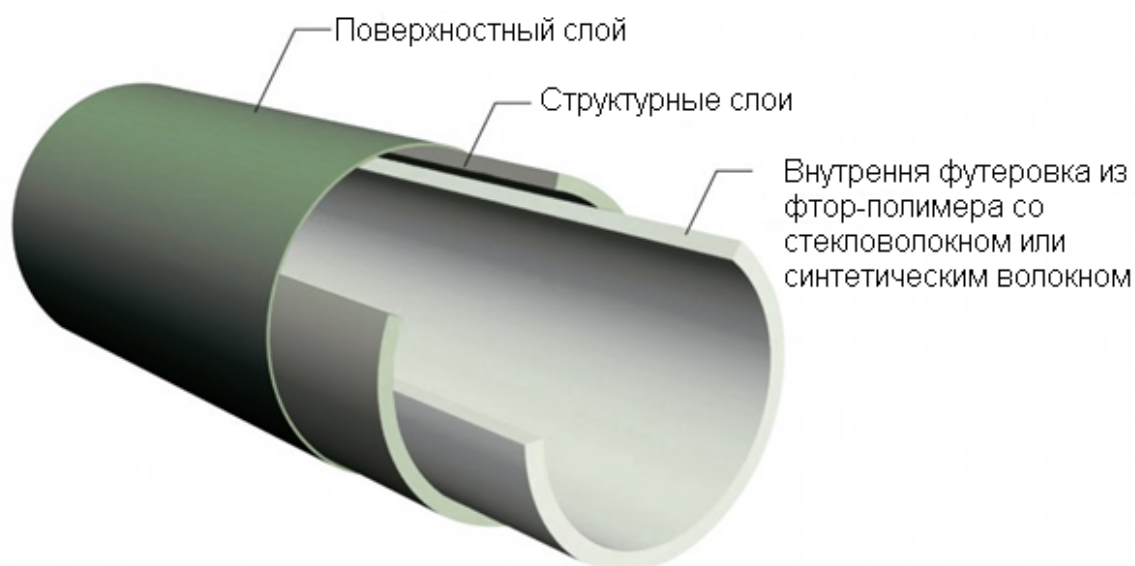
Рисунок 2. Типичная конструкция двойного коррозионностойкого ламината
