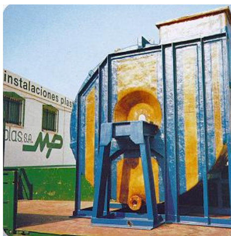
Рисунок 11. Вентилятор, работающий с дымами оксида фосфора при +80^{\circ}\text{C}
