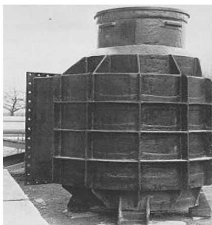
Рисунок 9. Стеклопластиковый сепаратор для восстановления фосфорной кислоты из отработанных дымов
