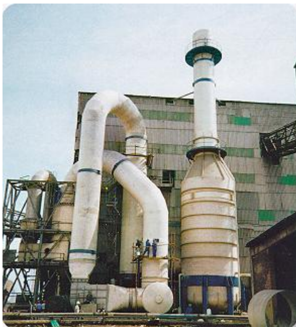
Рисунок 7. Стеклопластиковый скруббер для диаммоний фосфата
