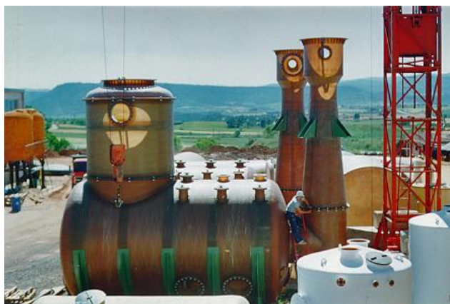
Рисунок 10. Скруббер Вентури для аммиака и сероводорода
