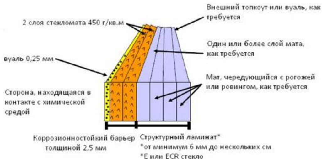
Рисунок 2. Конструкция типичного коррозионностойкого стеклопластика
