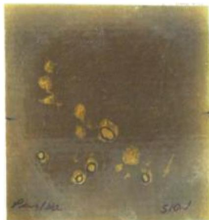
**Рисунок 12 – DERAKANE 510N Br NEVER СП ламинат на основе углеродной вуали и С-стекловуали, находившийся в тестовом растворе 36 недель и затем 1 час при 204 °С**
