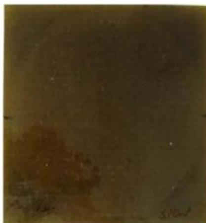
**Рисунок 9 – DERAKANE 510N Br NEVER СП ламинат на основе углеродной вуали и С-стекловуали, находившийся в тестовом растворе 24 недели и затем 1 час при 204 °С**
