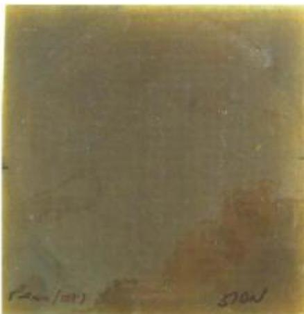
**Рисунок 11 – DERAКANE 510N Br NEVER СП ламинат на основе углеродной вуали и С-стекловуали, находившийся в тестовом растворе 36 недель и затем 1 час при 182 °С**
