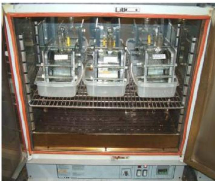
**Рисунок 2 –Тестовые ячейки Atlas в печи**
