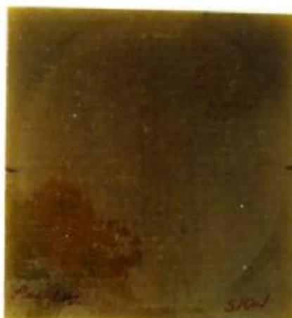
**Рисунок 8 – DERAKANE 510N Br NEVER СП ламинат на основе углеродной вуали и С-стекловуали, находившийся в тестовом растворе 24 недели и затем 1 час при 182 °С**
